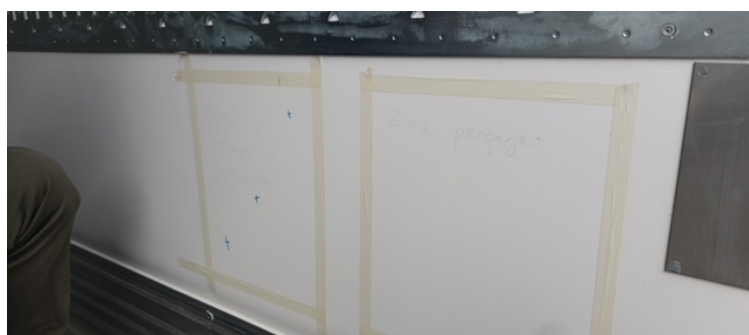
Photo n°1 : emplacement des perçages sur la paroi intérieure d'un prototype d'engin de transport sous température dirigée (© Cemafrroid)
