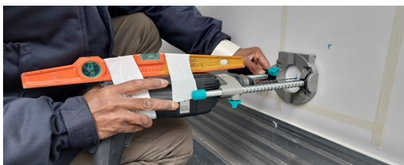
Photo n°2 : perçage d'un panneau sur la paroi intérieure d'un prototype d'engin de transport sous température dirigée (© Cemafrroid)
