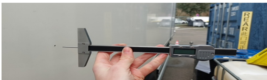
Photo n°3 : mesure par jauge de profondeur de l'épaisseur de la paroi d'un prototype d'engin de transport sous température dirigée (© Cemafröid)
